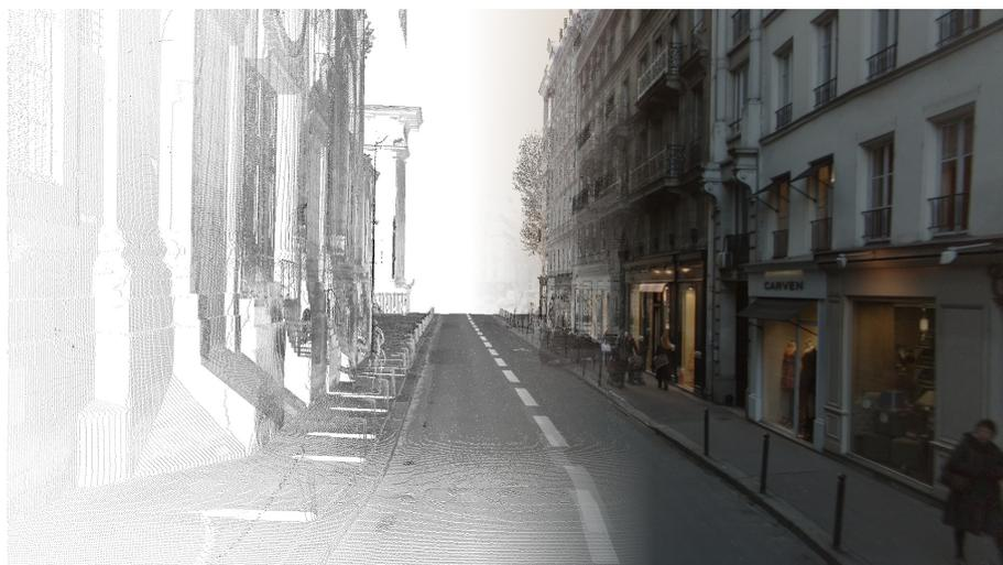
FIGURE 2.10 – Superposition d’une image et d’un scan laser de la même scène.
