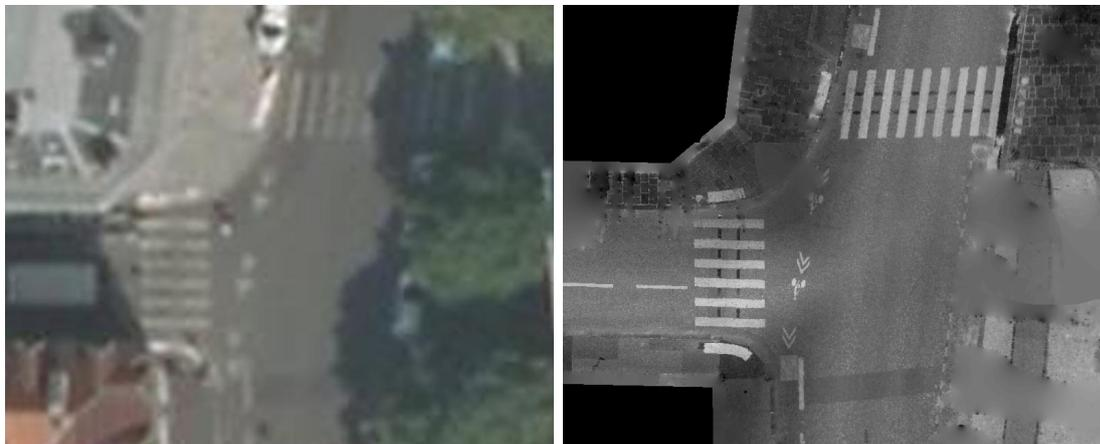
FIGURE 2.32 – Orthoimage aérienne (gauche) et laser terrestre (droite). La seconde est plus précise, présente moins d’occlusions et est insensible aux conditions d’éclairage
