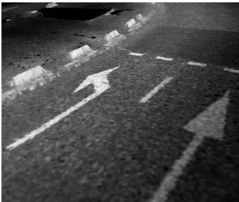
FIGURE 2.33 – Modèle 3D de sol texturé réalisé à partir d’un scan de cartographie mobile.
