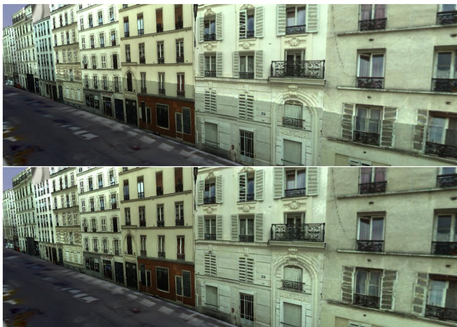
FIGURE 2.31 – Texturation sans (haut) et avec (bas) égalisation radiométrique non paramétrique de façades à partir d’images de cartographie mobile
