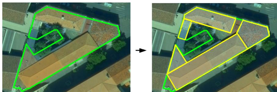
FIGURE 2.23 – Illustration du problème de redécoupage d'empreintes cadastrales. L'utilisation des discontinuités altimétrique ne permet pas toujours de décomposer les structures architecturales individuelles.
