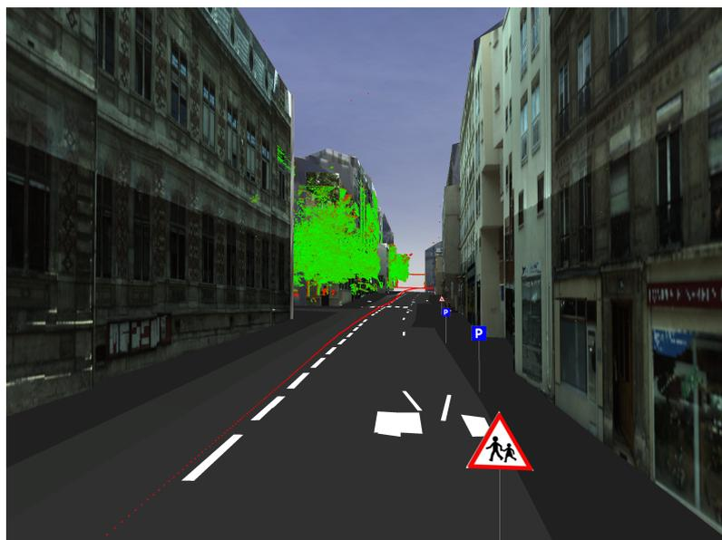
FIGURE 4.1 – Visualisation dans GeoLabX d'un modèle 3D texturé de ville produit à partir d'images aériennes et enrichi par cartographie mobile : surface de sol reconstruite et séparée entre route et trottoir, marquages au sol et panneaux reconstruits en 3D, arbres détectés et individualisés intégrés sous forme de nuages de points
