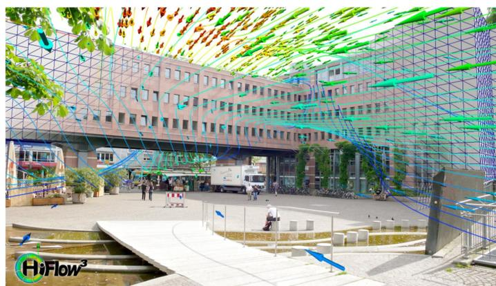
Fig 1: Visualisation du vent en utilisant un mix de techniques de visualisation de flux 2D [2].
